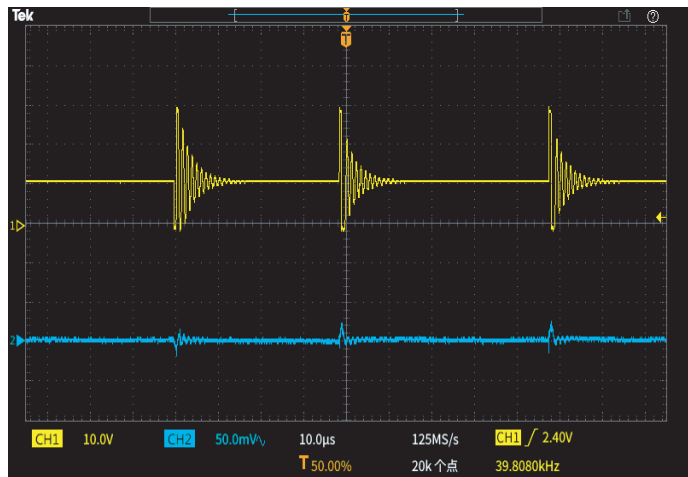
图 7，SW波形 vs. 输出纹波， I_{LOAD}=0A
